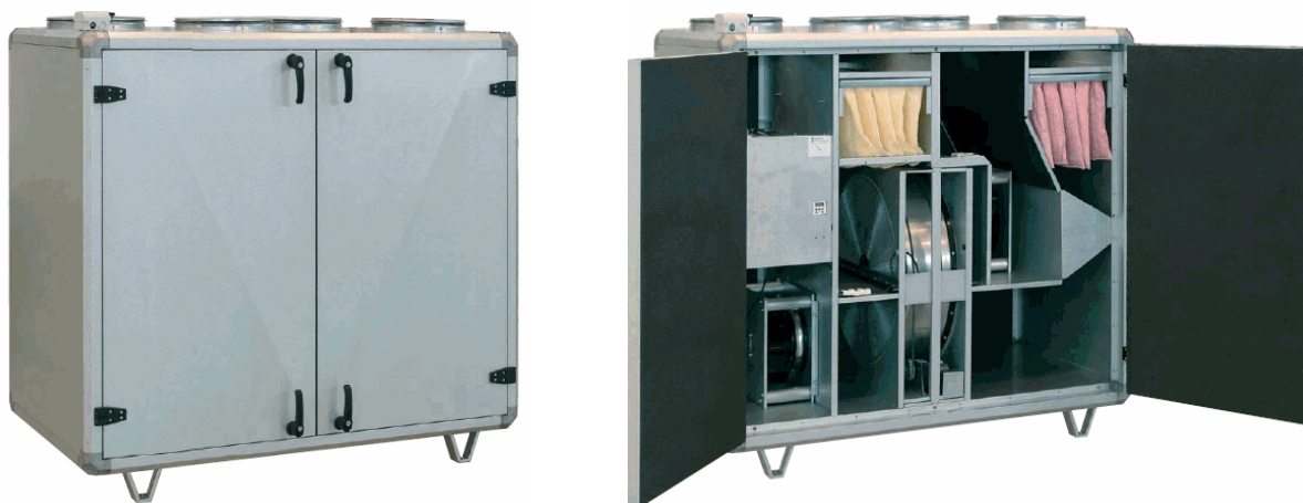
Figur 12 Eksempel på komplett "Topvex" luftbehandlingsaggregat fra Systemair med roterende høyeffektiv varmegjenvinner, filter og varme/kjølebatteri. Et aggregat med ytre dimensjoner 1,48x1,28x0,85 m har en angitt nominell luftmengde på 375 l/s ( http://www.systemair.no )
